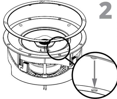
**2** Placez l'anneau en caoutchouc sur l'enceinte de façon à ce que les 8 œillets en caoutchouc soient alignés sur les 8 trous de l'enceinte; appuyez fermement pour raccorder l'anneau à l'enceinte.
