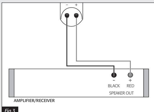
rouge (+) de l'enceinte, et la borne noire (-) à la borne noire (-) de l'enceinte. Serrer manuellement les vis des bornes, fermement mais cependant sans excès.
